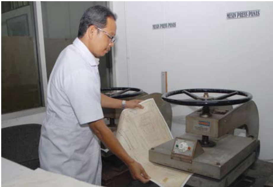
Proses pengepresan arsip dengan menggunakan mesin press pemanas
