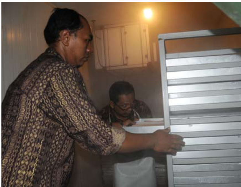
Proses Freezing. Arsip yang terendam banjir dikeringkan dengan menggunakan mesin Dry Chamber.
