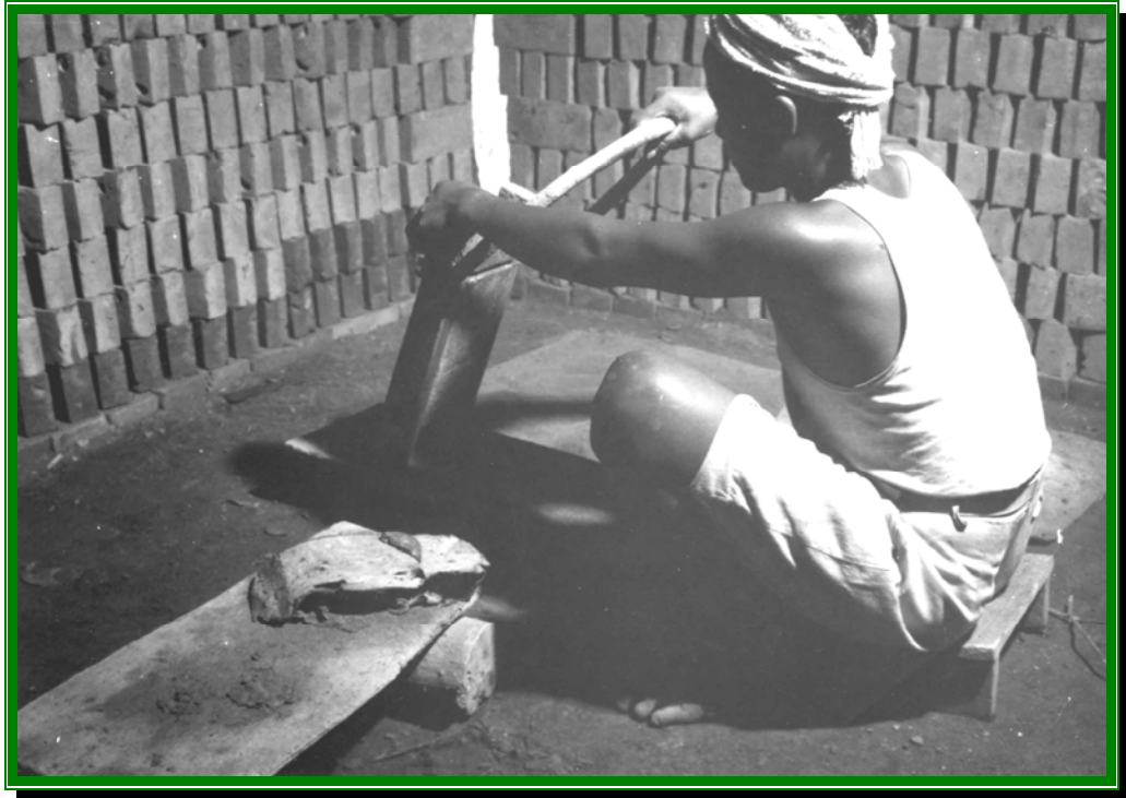
Seorang pekerja sedang mencetak batu bata yang terbuat dari tanah liat di Perusahaan Genting dan Batu bata Melati di Jambi, 4 Desember 1953. Kempen 531204 DD 1
